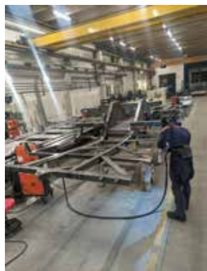
Zusammenbau des Chassis.
